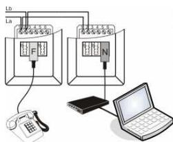
Das Telefon und das Modem haben jeweils die Drähte La und Lb als Signalleitung. Beide Geräte sind gleichzeitig parallel angeschlossen. Mit einem Y-Adapter können diese zusammengeschlossen werden.
